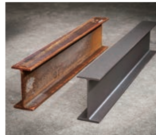
錆びや汚れのついた状態の鉄骨（左）と、ショットブラストマシンにより研掃を行った鉄骨（右）。
