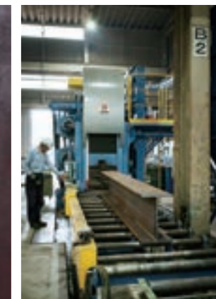
ベルトコンベアでマシン内に送られる鉄骨。
