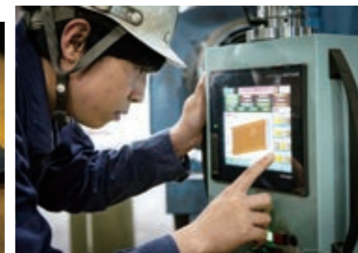
手元の操作パネルで、研掃の細かな設定をする。
