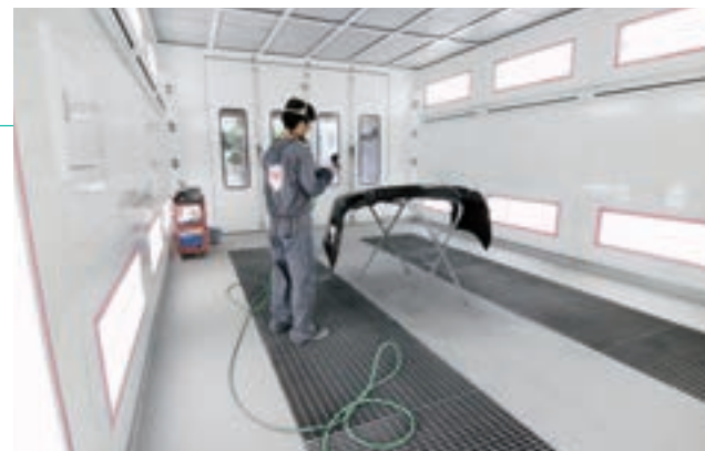
水性塗装ブース内での作業の様子。ブース内12カ所から強力な風が送り込まれ、乾燥を速める。
