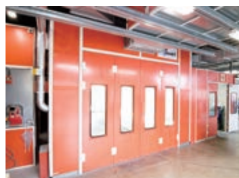
鮮やかなオレンジ色の水性塗装ブースの外観。大型自動車も対応可能となっている。
