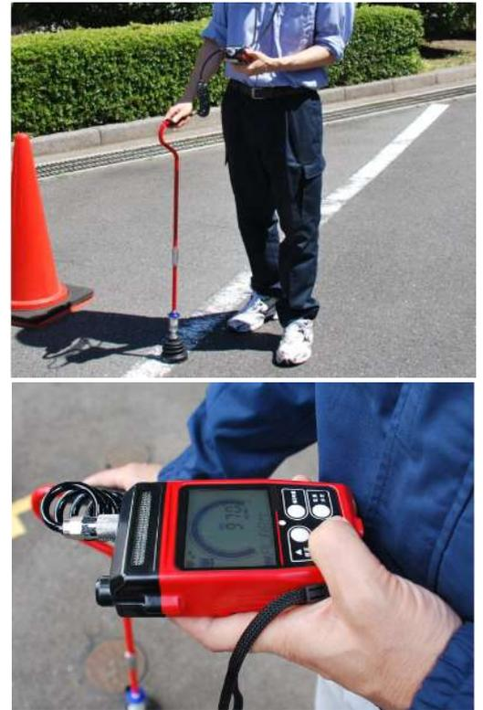
【微小漏水検知機により検査を行う様子】
