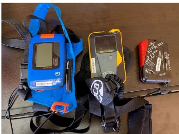
【補助事業で導入した雪に埋没した救助者を捜索するためのビーコン】
