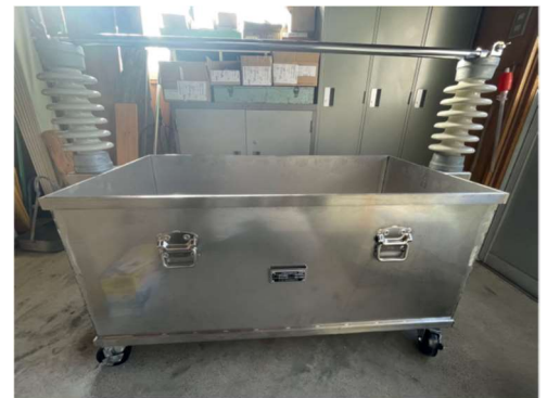
【補助事業で導入した耐圧試験装置】
